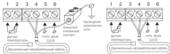
Схема подключения к 3-х проводной электрической сети
